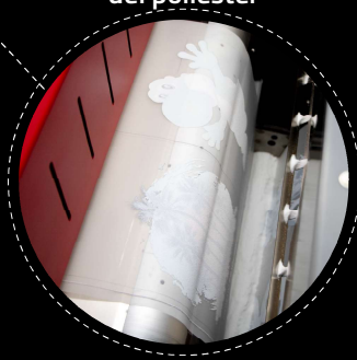
Rodillo de succión que mejora el avance del poliéster
