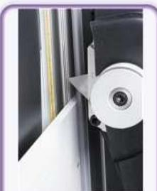
**Exclusivo** - Cabezal de corte de revólver universal con separación automática de la cuchilla al final del corte
